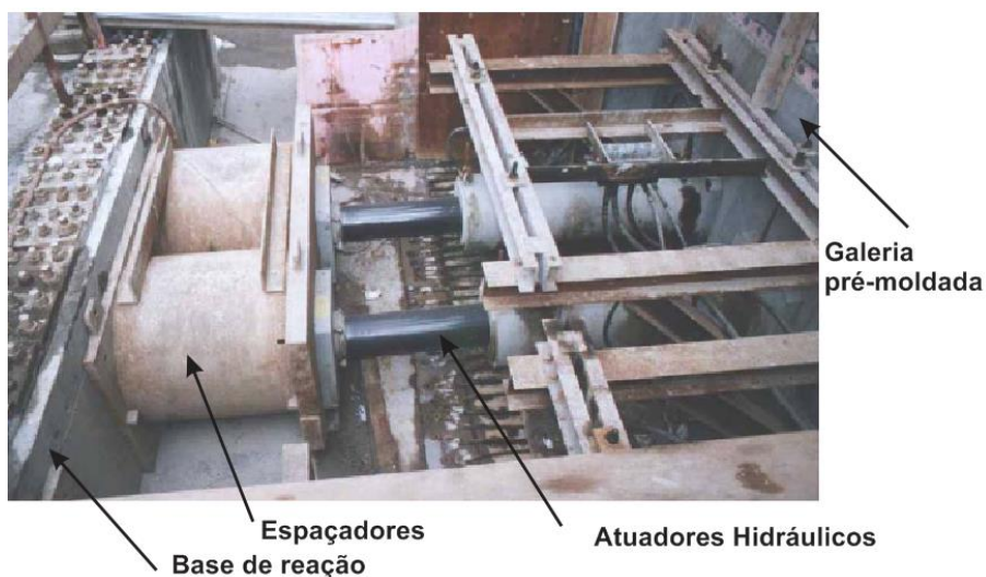
Figura 16 - Detalhe dos atuadores hidráulicos
